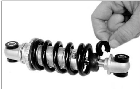
Durch das Aufstecken von Distanzclips auf die Kolbenstange des Federelementes wird der Federweg eingestellt.
