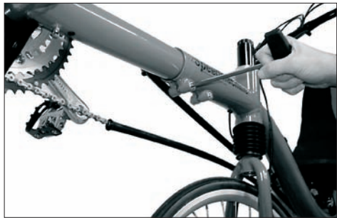
Lösen der Klemmschrauben zum Verstellen des Tretlagerauslegers.
