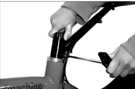
Dämpfungseinstellung durch Drehen der Abdeckkappe.
