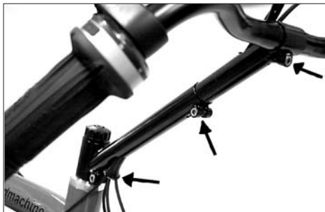
Am Lenkervorbau befinden sich drei Klemmschrauben zur Längeneinstellung.
