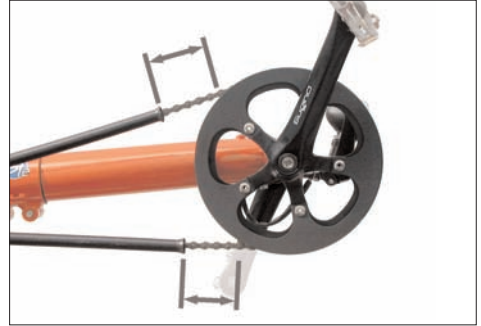
Zwischen den Enden der Kettenschutzrohre und den Schaltungsteilen muss bei gespannter Kette mindestens 5 cm Abstand verbleiben.
